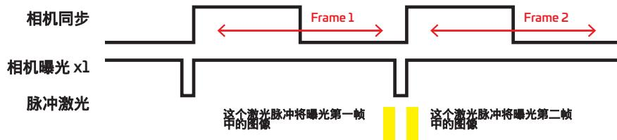
**单幅内两次曝光:** 如果用户试图理解子弹的运动，他们会提高高速摄像机的帧速度，以看到足够的运动帧；增加帧率会降低分辨率。这种双采样(双曝光)的新方法意味着相机可以以一半的速度运行，并受益于两倍的分辨率。
